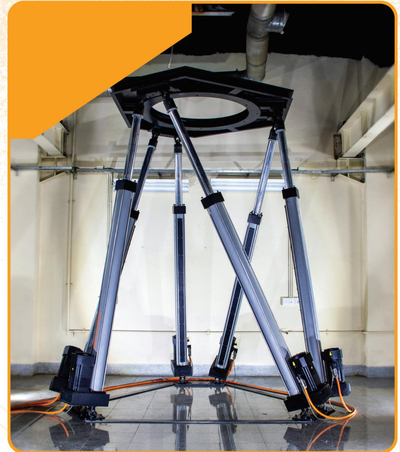
طراحی هگز‌اپاد AxisXtreme به گونه‌ای است که توانایی ایجاد حرکت Heave با دامنه ۰.۹ متر و اعمال شتاب معادل یک برابر شتاب گرانش را دارد که آن را به گرینه‌ای ایده‌آل برای شبیه‌سازی واقع‌گرایانه دینامیک حرکت تبدیل می‌کند. امکان طراحی این ربات با توجه به نیاز کارفرما بوده و در صورت نیاز به مشخصات متفاوت از مقادیر ذکر شده در این جدول، ربات با توجه به نیاز کارفرما شخصی‌سازی خواهد شد.
