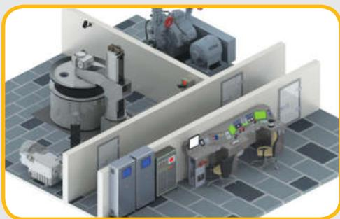
طراحی ای اوت و تجهیزات آزمایشگاه اسپین تستر-Spin Tester
